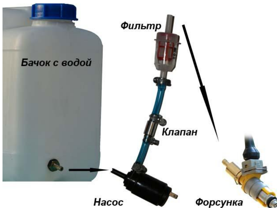
Рисунок 3.2. Схема подключения шлангов в системе с простым насосом.
